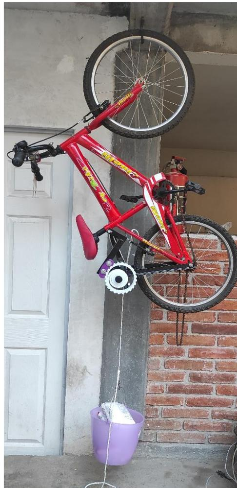
Figura 4-19 Resorte torsional espiral plano topología 1 impreso con un relleno del 50% de Nylon 6 sometido a la prueba del **TMP** con un torque aplicado de 3.3512 N-m (Autoría propia, 2024).
