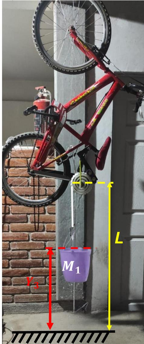
Figura 3-16 Sistema en el estado 2, resorte torsional sin deformación, Carga  $M_1$  @  $Y_2$  (Autoría propia, 2024).
