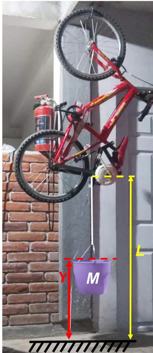
Figura 3-8 Sistema diseñado para determinar el torque aplicado al resorte torsional mediante la carga suspendida  $M$  (Autoría propia, 2024).
