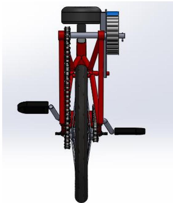
Figura 4-8 Vista posterior del diseño CAD del prototipo del sistema con el brazo bloqueando el resorte espiral plano topología 1 (Autoría propia, 2024).
