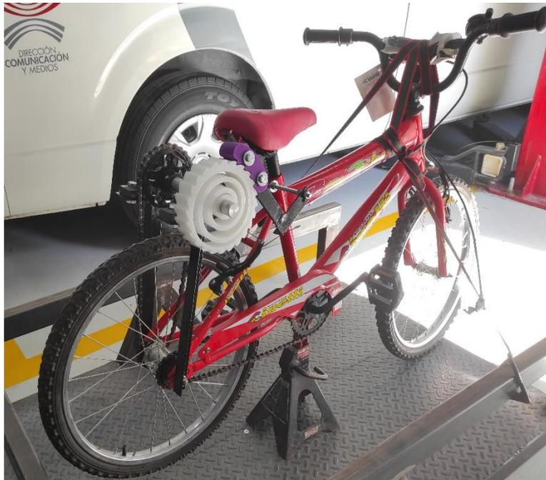
Figura 4-18 Prototipo de la bicicleta con el sistema de captación de energía implementado empleando la Topología 1 del resorte espiral plano impreso al 50% de relleno de Nylon 6 (Autoría propia, 2024).
