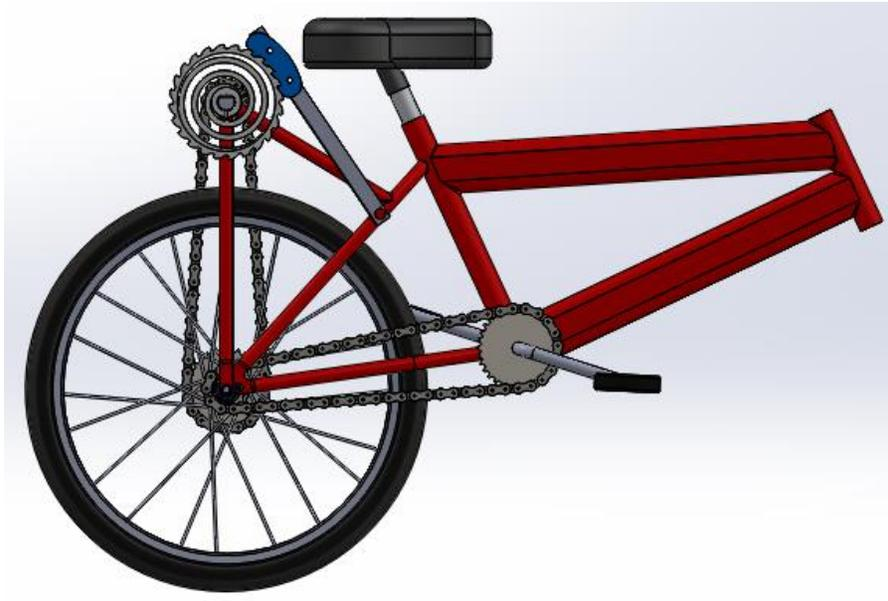
Figura 4-7 Vista lateral del diseño CAD del prototipo del sistema con el resorte espiral plano topología 1 bloqueado (Autoría propia, 2024).
