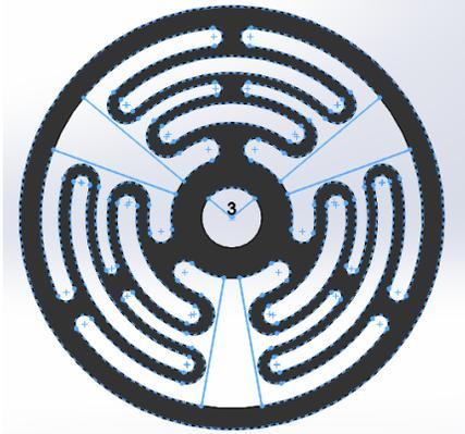
El diagrama muestra un resorte torsional con una geometría circular y simétrica. El resorte está dividido en tres secciones radiales, cada una representando un brazo. En el centro del resorte, hay un círculo pequeño con el número '3' dentro, lo que indica el número de brazos. Las líneas del resorte se curvan hacia el exterior, formando una estructura similar a un laberinto o una espiral compacta. |
