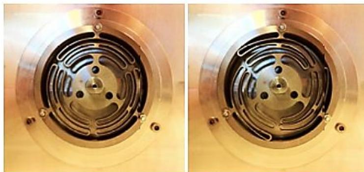
Figura 2-4 Resorte en estado descargado [izquierda] y en estado deformado [derecha] con torque aplicado de 7.68 N·m (Carpino et al., 2012).
