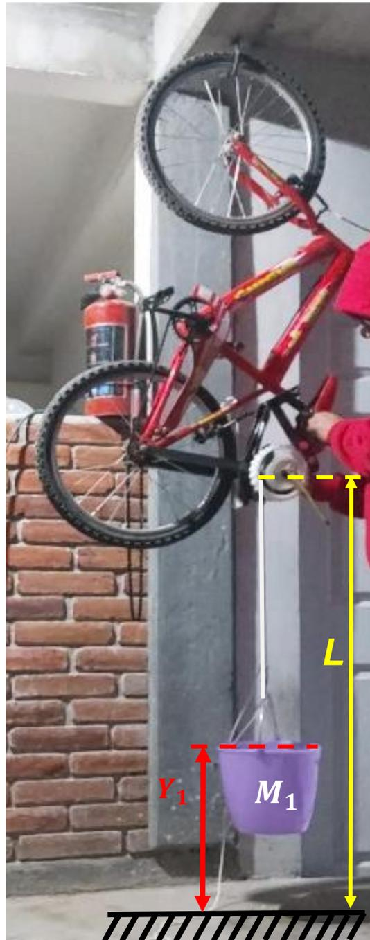
Figura 3-13 Sistema en el estado 1, resorte torsional deformado al máximo @TMP, Carga  $M_1$  @ $Y_1$
