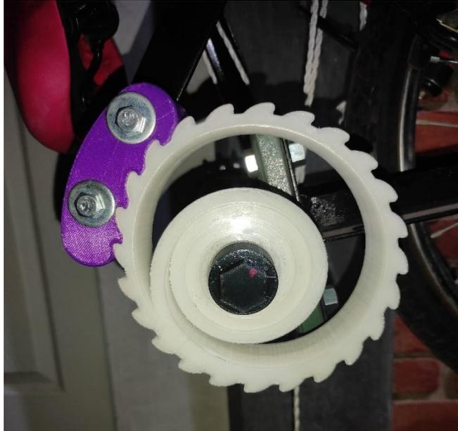
Figura 4-20 Resorte torsional espiral plano topología 1 impreso con un relleno del 50% de Nylon 6 con un torque aplicado de 3.3512 N-m (Autoría propia, 2024).
