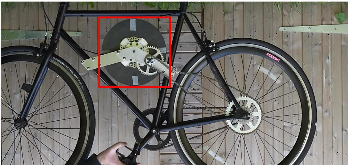
Figura 1-4 KERS implementado en una bicicleta con volante de inercia. (Stanton, 2021).
