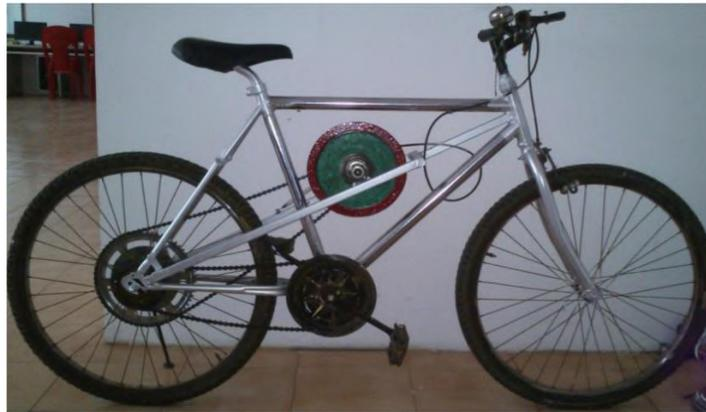
Figura 1-2 Sistema KERS en una bicicleta con volante de inercia (Menon et al., 2013).
