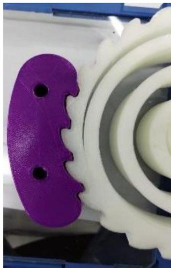
Figura 4-16 Acoplamiento de geometrías del sistema de bloqueo del resorte torsional impresas en 3D de PLA con relleno al 30% (Autoría propia, 2024).
