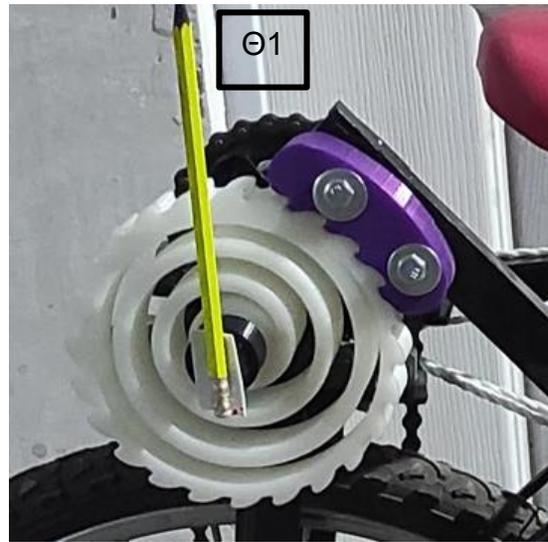
Figura 3-10 Posición no deformada del resorte torsional, lápiz en ángulo de  $\Theta_1$  (Autoría propia, 2024).
