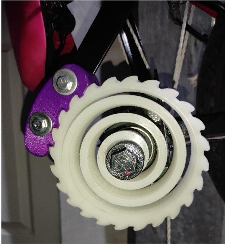
Figura 3-17 Resorte torsional de nylon 6 sin deformaciones en el estado 3 (Autoría propia, 2024).
