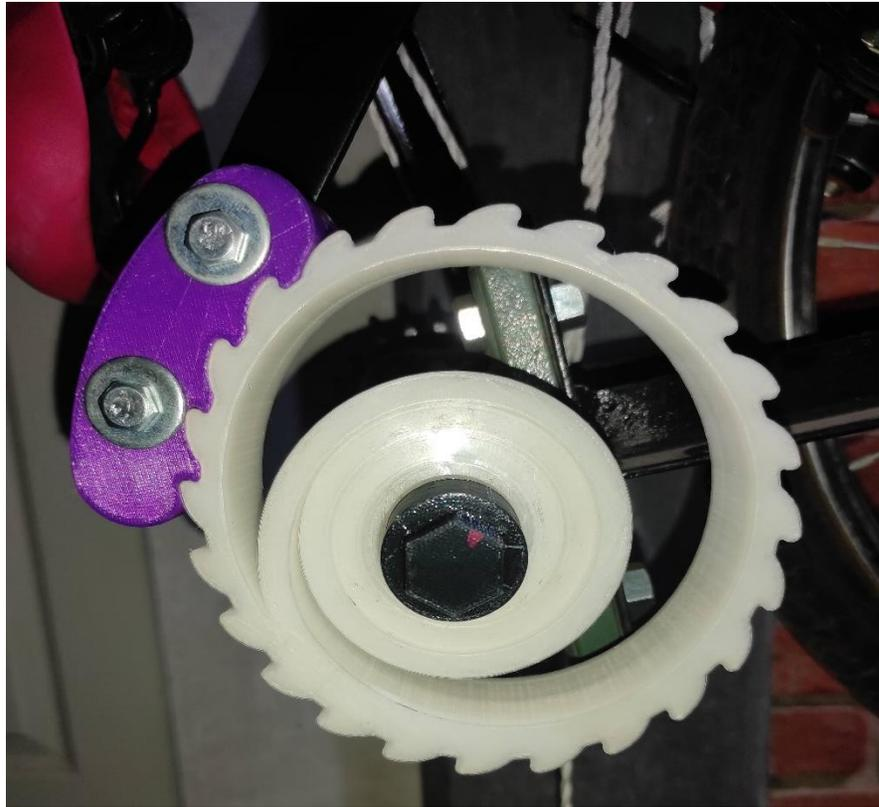
Figura 3-14 Resorte torsional de nylon 6 deformado elásticamente al máximo en el estado (Autoría propia, 2024).
