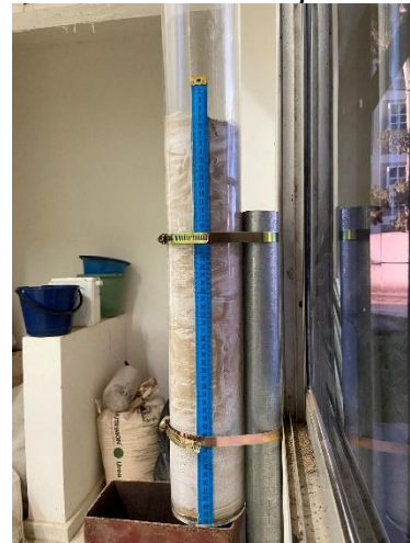
Montaje de la prueba para C1
