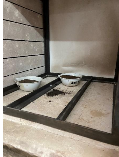
Pruebas de humedad para las muestras.
