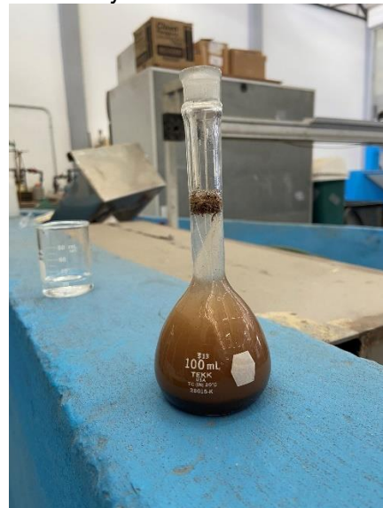
Prueba de densidad para los suelos.
