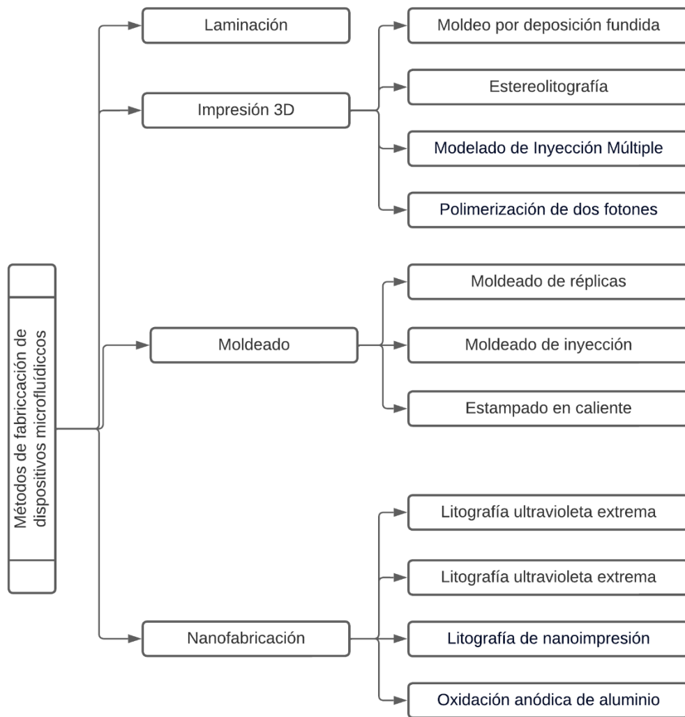
Figura 15. Diferentes métodos para la fabricación de dispositivos microfluídicos (Jurinjak Tušek et al., 2021).
