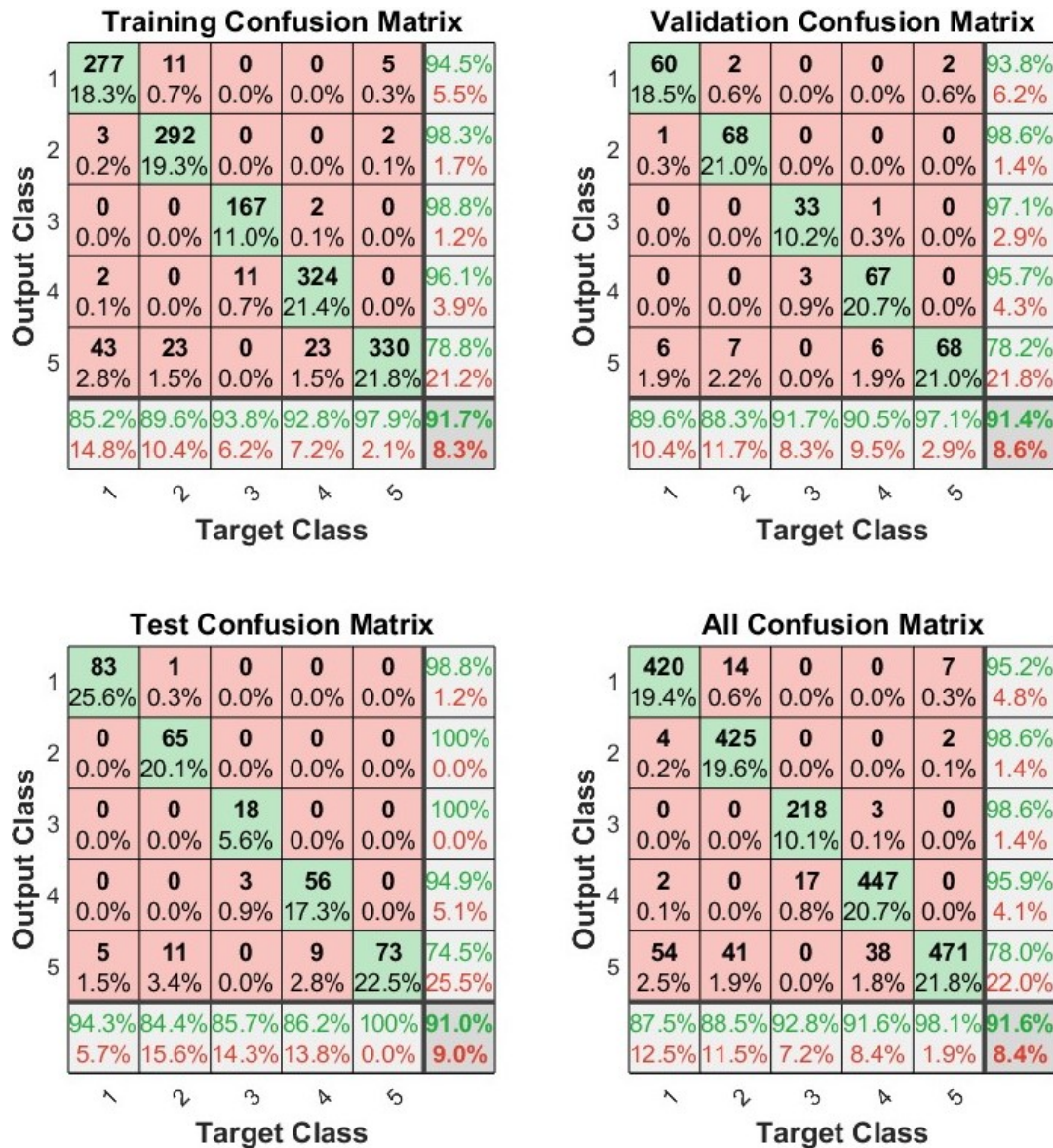
Figura 4.1: Matriz de confusión generada por la red patternet con 25 neuronas en la capa oculta, una tasa de aprendizaje de 0.005 y 5000 épocas utilizando el conjunto de datos generado con la cámara CCD.
