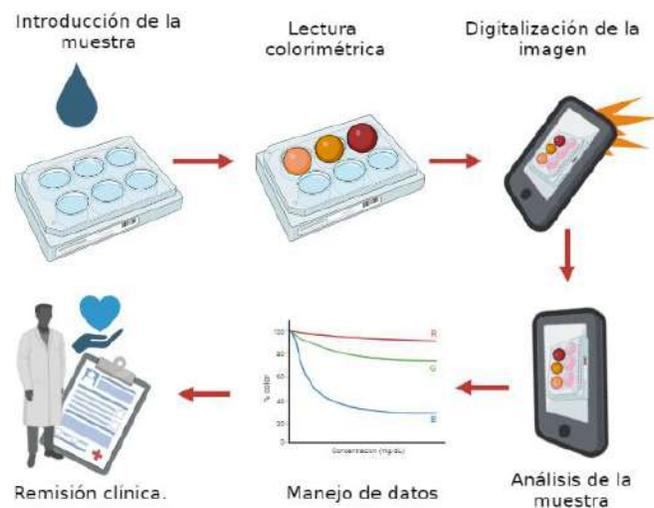
Figura 11. Proceso de obtención de resultados de un dispositivo colorimétrico microfluídicos.
