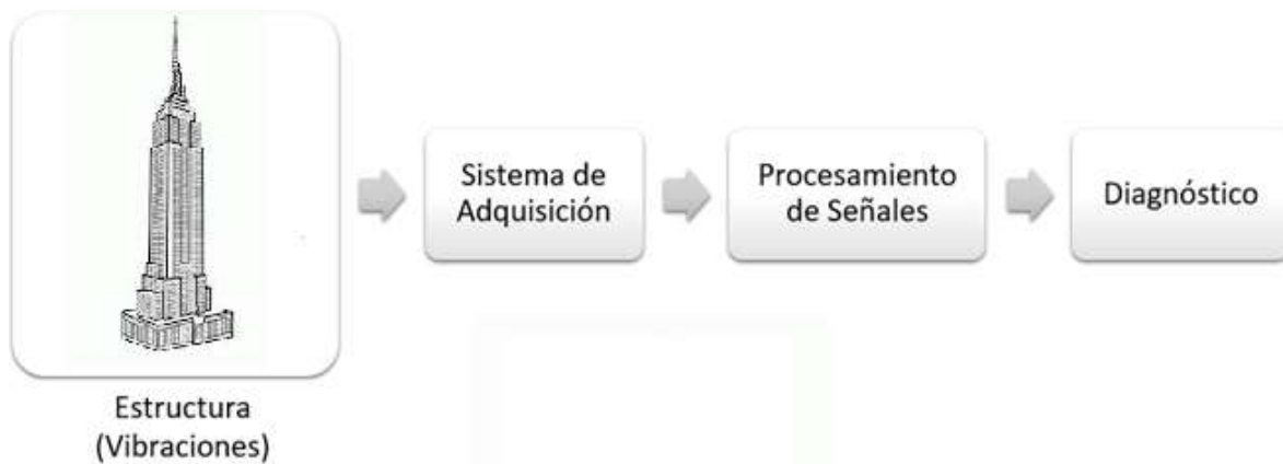
Figura 2.2 Esquema de un Sistema de monitoreo para la integridad estructural
