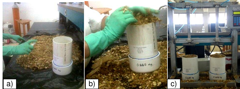
Figura 1. Inoculación del forraje de maíz: a) aspersión del inóculo; b) llenado del microsilo, y ligera compresión manual del forraje dentro del microsilo y c) compactación mecánica de los microsilos.
