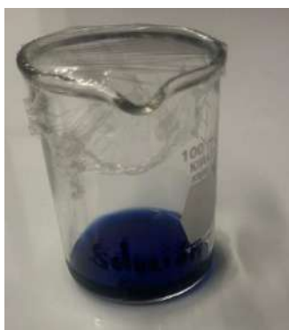
Figura 5.1: Solución precursora para el depósito de las películas delgadas de \text{Cu}_2\text{O} a partir de dietanolamina (DEA) y nitrato de cobre hidratado ( \text{Cu}(\text{NO}_3)_2 )
