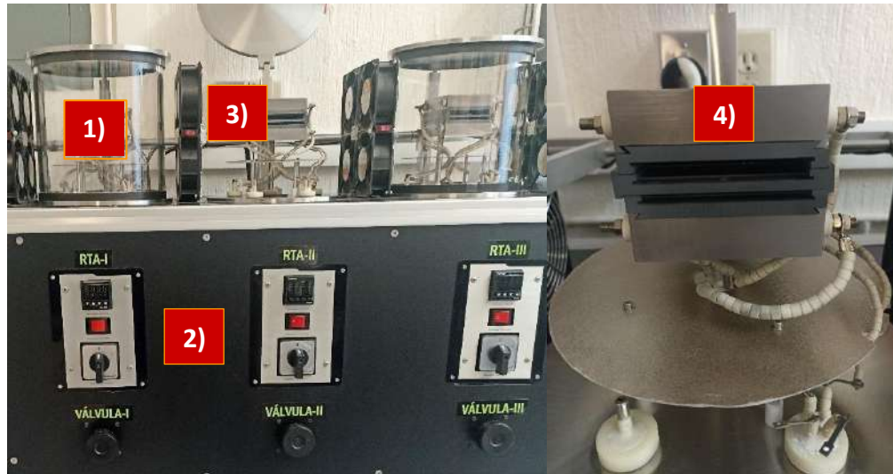
Figura 4.4. Componentes externos del equipo RTA, 1) cámara de tratamiento, 2) panel de control, 3) ventiladores de enfriamiento, 4) calefactores de acero.
