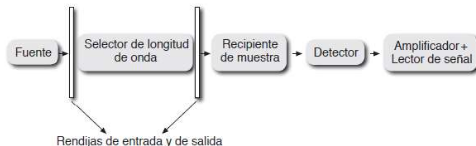
Figura 2.8. Esquema de los componentes más básicos de los equipos de UV-Vis (Faraldos, M & Goberna, C., 2021).
