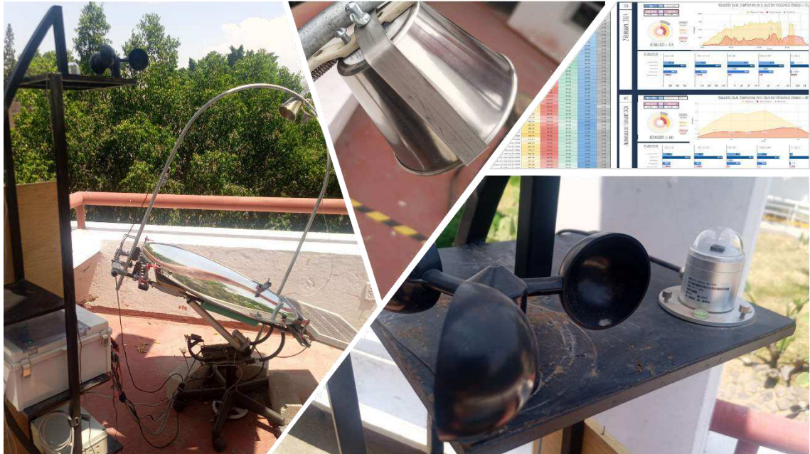
Fig. 3.20. Prototipo de SDP con SS con la integración de la arquitectura IoT.
