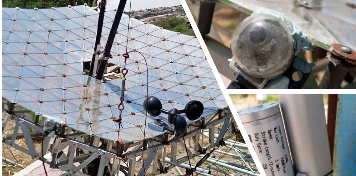
Fig. 2.1. Concentrador solar de disco parabólico
