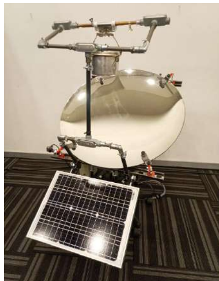
Fig. 3.9. Prototipo experimental del horno solar.
