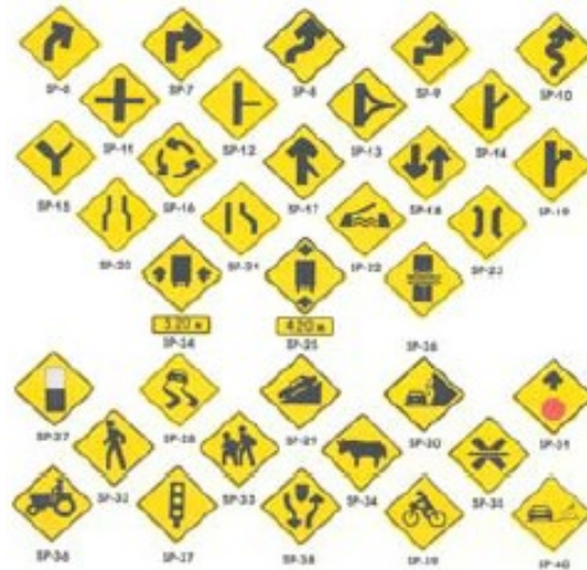
Figura 3.6.1 Señales preventivas por SCT emitidas en el manual para el control de tránsito y calles.
