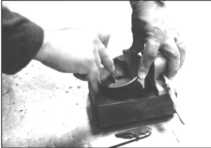
Figura 2.1.2 Copa de Casa Grande para la determinación del LL.
