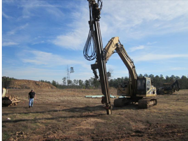
Figura 2.28. Barrenadora para colocación de explosivos (Caterpillar).
