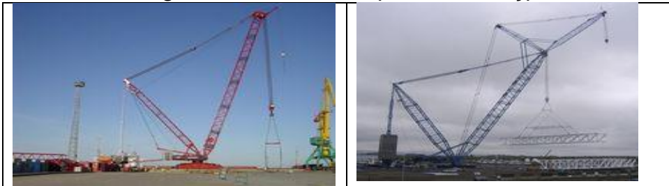
Figura 2.33. Grúa mástil operando con dos o más torres o plumas (Direct Industry).
