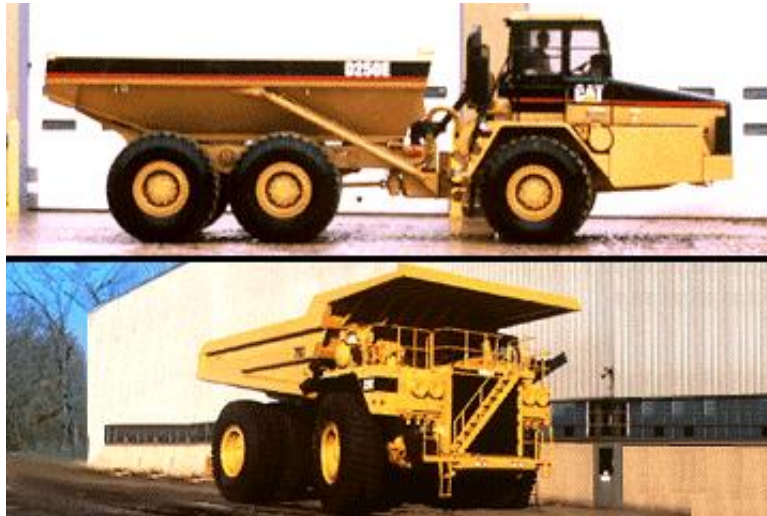
Figura 2.10. Equipo de acarreo para manejo de material para construcción ( Finning Caterpillar ).
