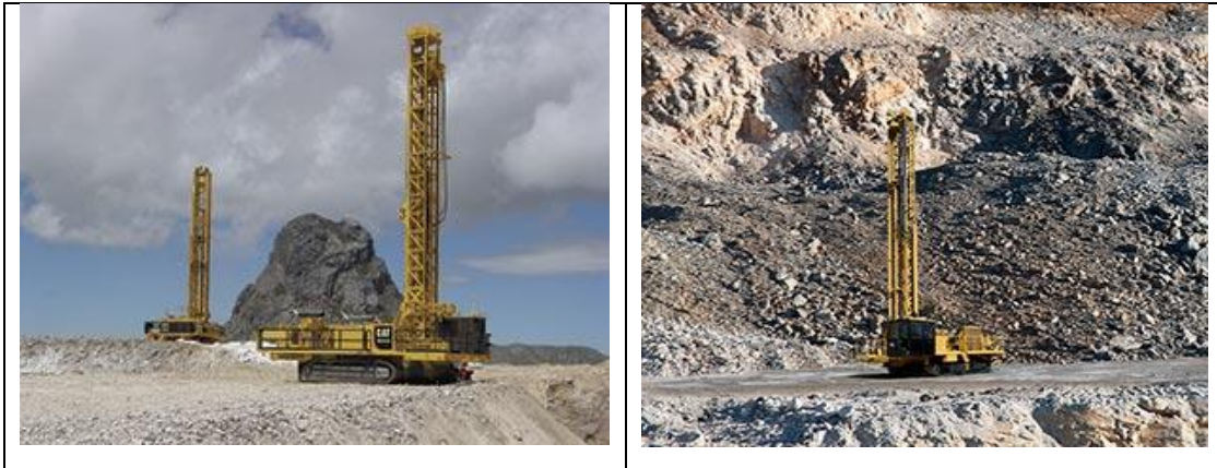
Figura 2.26. Maquinas rotativas de perforación de torre montadas sobre orugas ( Caterpillar ).
