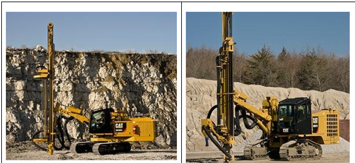
Figura 2.27. Perforadoras de percusión montadas sobre orugas (Caterpillar).
