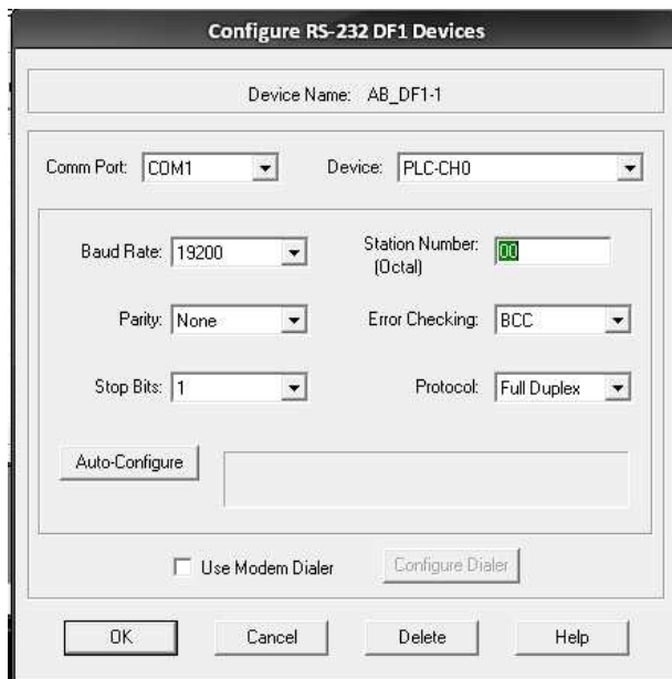
Figura 38. Ventana de configuración del controlador
