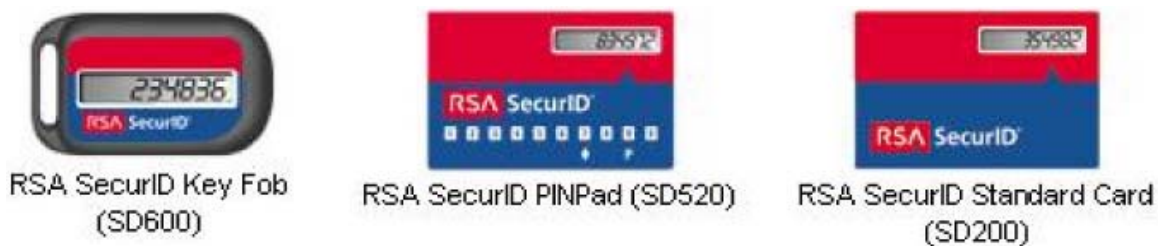
Figura 3.4: Se ilustra la imagen del hardware que genera los gizmos proveídos por la seguridad de RSA para su esquema en la autenticación del factor de SecurID “dos factores”.
