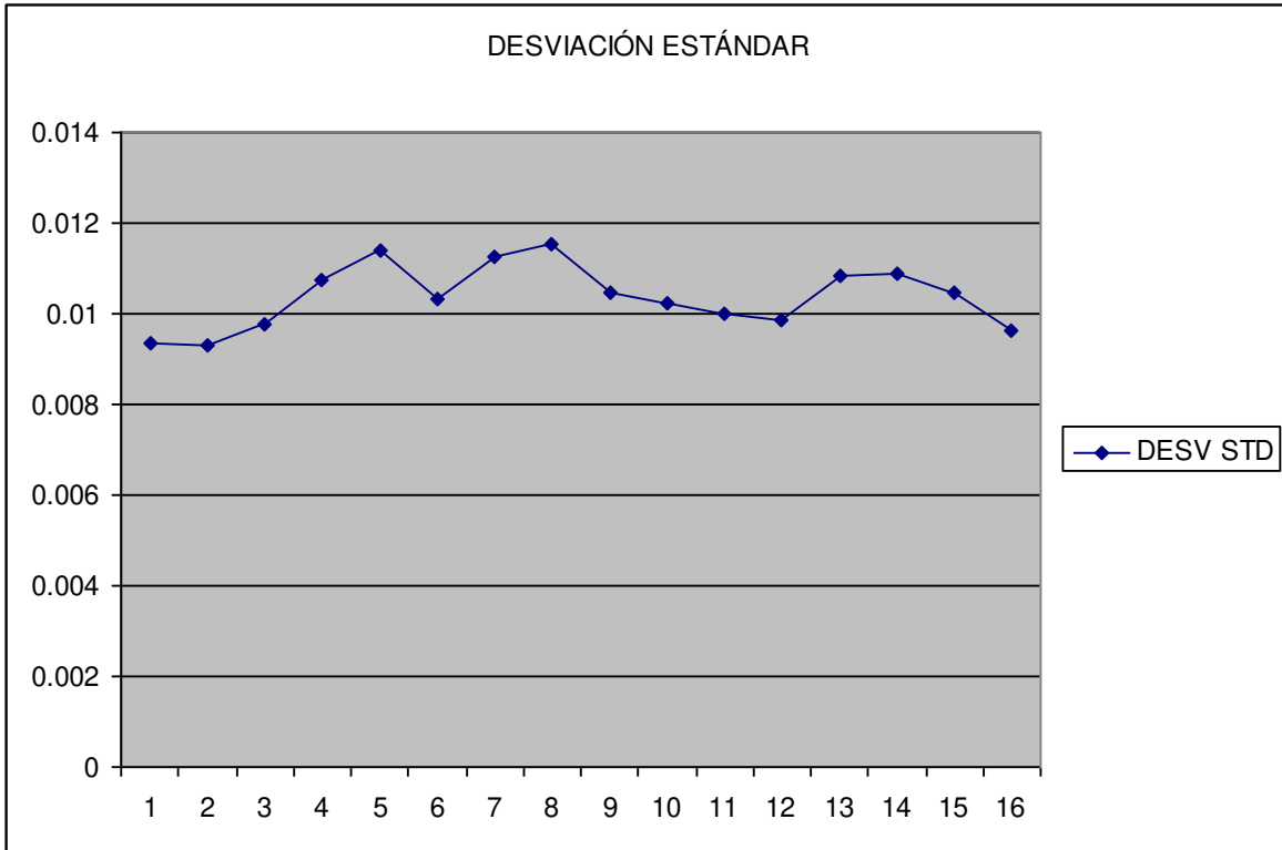
Figura 4.6.1.- Desviación estándar de los tiempos utilizados en el traslado de los paquetes en un sistema distribuido en tiempo real.
