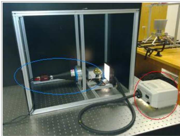
Figura 4.3 En azul se muestra la cámara telecéntrica y en rojo la fuente de energía de la lámpara Dolan-Jenner® .
