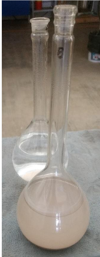
Figura 3-2.- Prueba de Hidrómetro.
