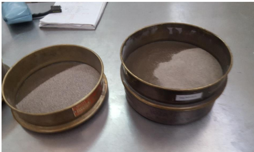
Figura 3-1 Cribado por la malla #200
