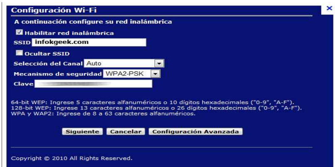
Figura 4.4.3 Consola de configuración de un Access point
