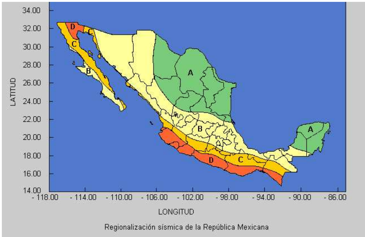
Figura 3.- Mapa de zonificación para diseño sísmico (Reglamento de Construcción para el Estado de Querétaro Arteaga.)
