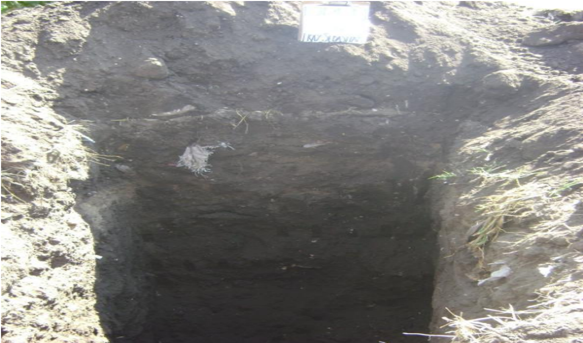
Figura 27.- Vista del sondeo No. 1. Se aprecia el relleno heterogéneo constituido principalmente por arcilla color café oscuro, desperdicio de construcción y basura.
