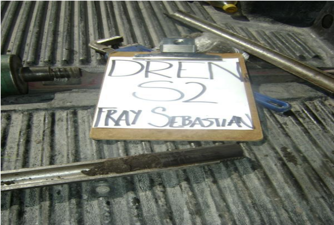
Figura 31.- Se aprecia la recuperación del material en el tubo muestreador después de realizar el ensaye de Penetración Estándar.
