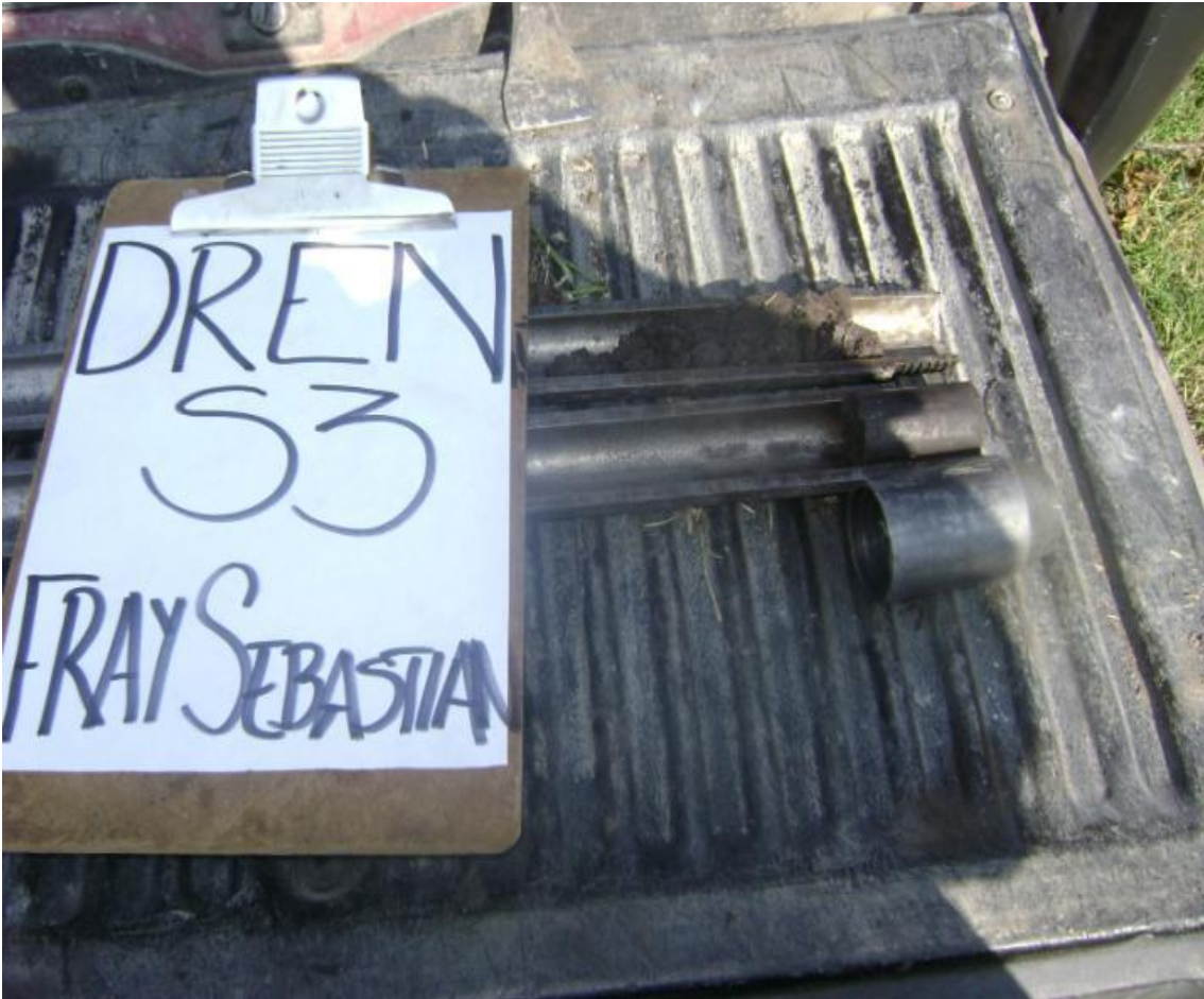
Figura 33.- Vista de la recuperación de material del ensaye de Penetración Estándar realizado en el sondeo No. 3
