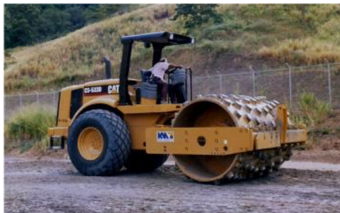
Figura 3.7 Compactadora pata de cabra
