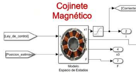
(b) Representación gráfica del cojinete magnético y su control.
