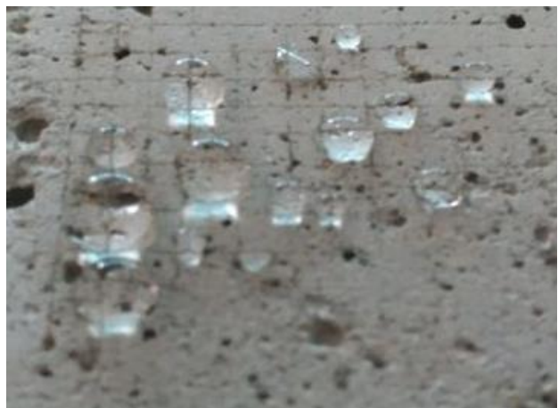
Fig. 46. Evaluación hidrofóbica de la superficie recubierta de \text{SiO}_2@\text{TiO}_2 con sonoquímica después del test de adherencia.
