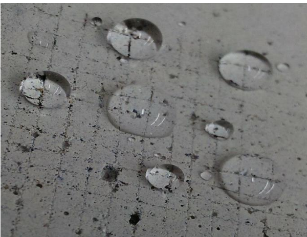
Fig. 46. Evaluación hidrofóbica de la superficie recubierta de \text{SiO}_2@\text{TiO}_2 sin sonoquímica después del test de adherencia.
