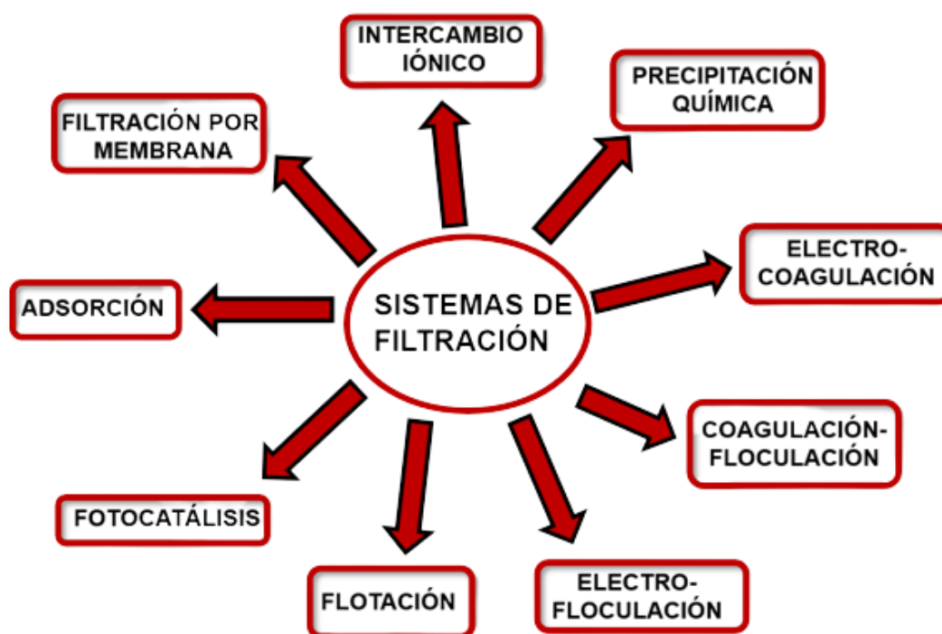
Figura 3 Sistemas de filtración de metales pesados en aguas residuales
