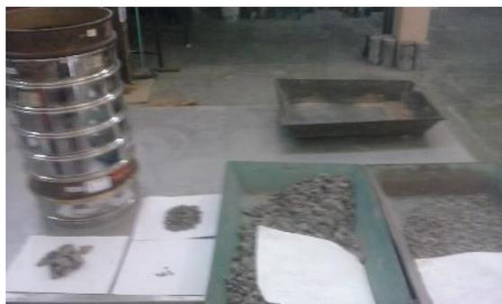
Figura 3.2 c) Cribado de agregados gruesos
