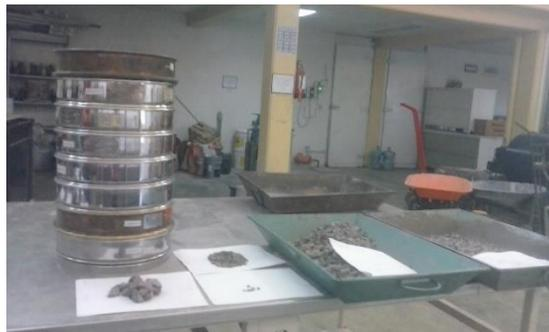
Figura 3.2 b) Cribado de agregados gruesos
