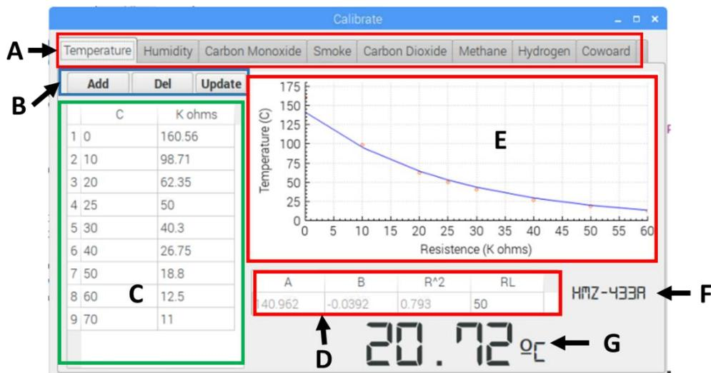
Figura 4-11. Pantalla para la calibración de sensores.
