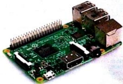
Figura 2. RPi 3 modelo B. La imagen muestra una tarjeta electrónica RPi 3 donde se aprecian sus componentes principales, entrada HDMI, puertos USB y los pines del GPIO. Fuente: [4].
