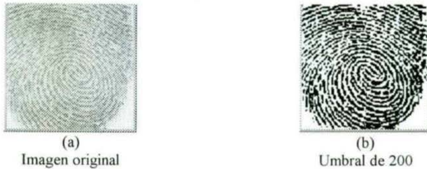
Figura 3.9 Aplicación de un umbral de 200 (imagen (b)) a la imagen en (a).
