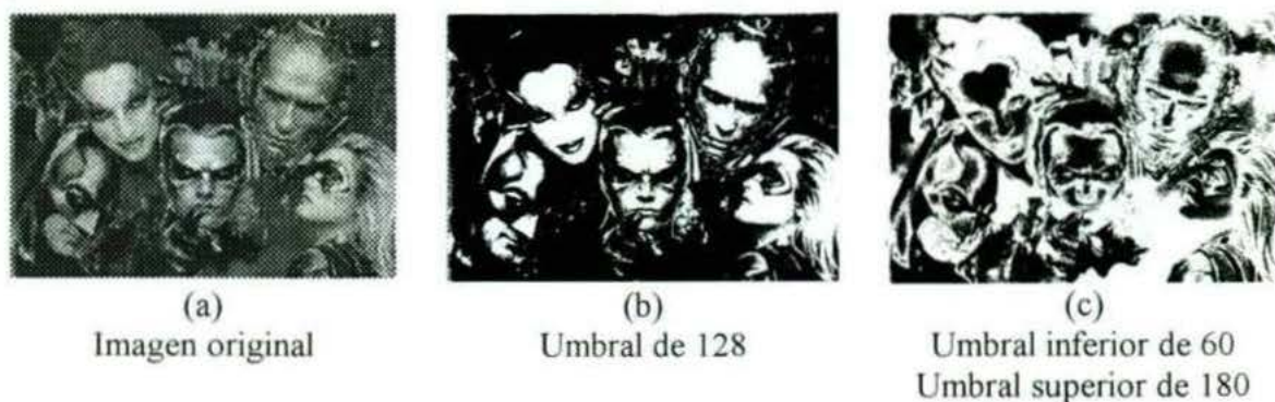
Figura 6.8 Resultado de la aplicación de binarización a la imagen en (a). Umbral de 128 en (b), Umbral inferior de 60 y superior de 180 en (c).
