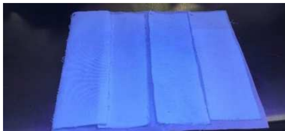
Figura 11 Muestras posterior al acondicionamiento, sometidas a luz UV para verificar que el detergente no posee abrillantador óptico.
