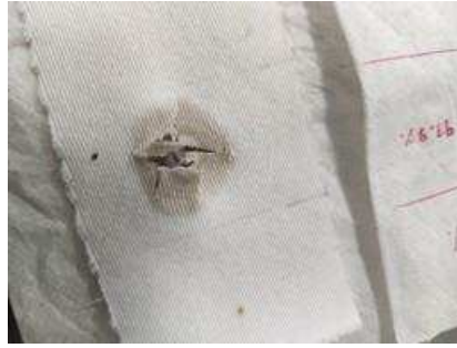
Figura 27 Corrosión después de la evaluación resultado del H_2SO_4 en el blanco sin recubrimiento.
