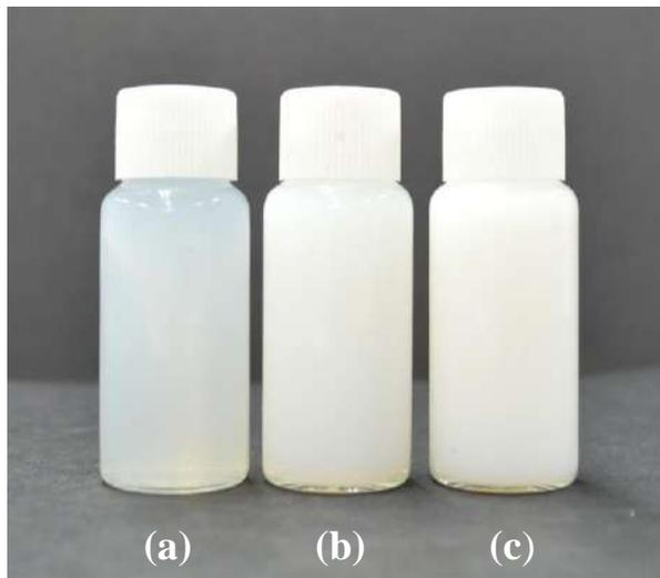
**Figura 14.** Apariencia de nanoemulsiones de aceite esencial de orégano mexicano obtenidas por sonicación durante 120 s. 0.25% (a), 1.0% (b) y 2.0% (p/p) de AEO (c).
