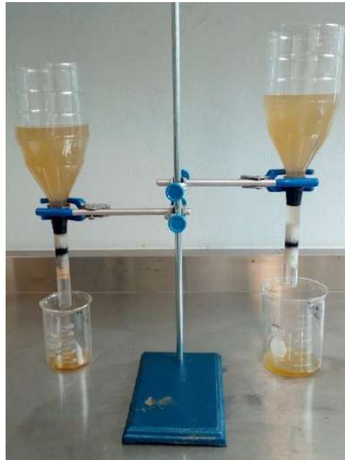
Figura 18. Tratamiento Físico mediante lechos empacados. Material: Eichhornia crassipes
