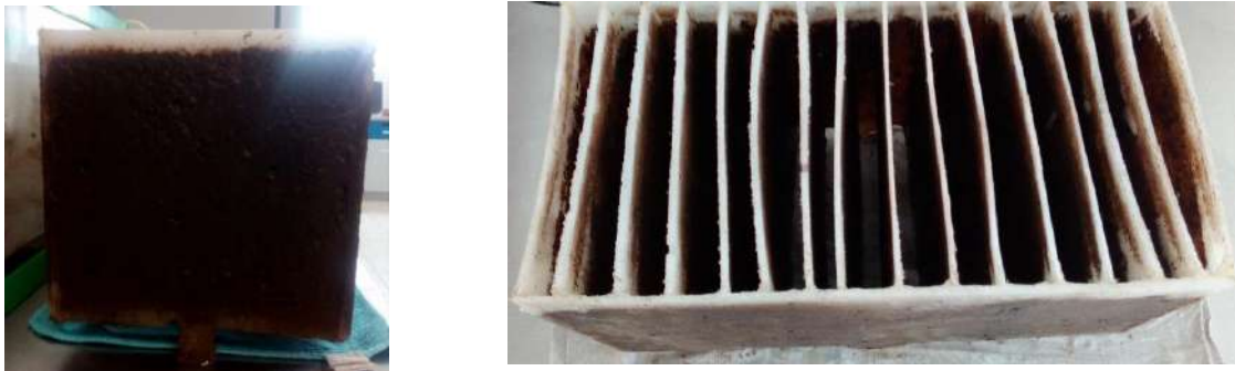
Figura 8. Adherencia del lodo al medio de soporte Polietileno de alta densidad (PEAD)
