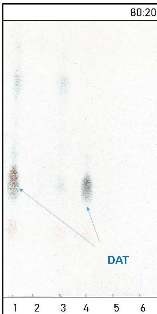
Figura 19. TLC analítica de purificación por columna Sep-pak de DAT. Orden de los carriles: 1) Fracción 80:20 del E.T. 2) 100:0 3) 95:5 4) 90:10 5) 88:12 y 6) 85:15 cloroformo/metanol (vol/vol). El DAT fue identificado por su  $R_f = 0.47$ .
