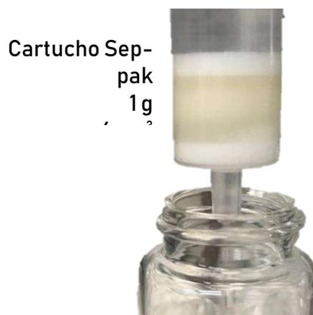
Figura 14. Purificación de glicolípidos mediante cromatografía en columna Sep-pak. Las fracciones purificadas fueron recuperadas en viales de centelleo y evaporadas a 60 °C bajo flujo de N<sub>2</sub>.
