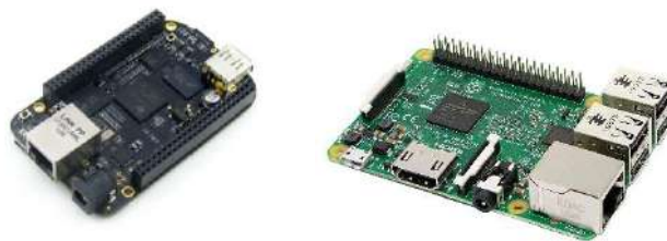
Figura 2. Tarjetas de desarrollo basadas en microprocesador, Beaglebone Black Rev C y Raspberry Pi 3 Model B. (Amazon, 2017).
