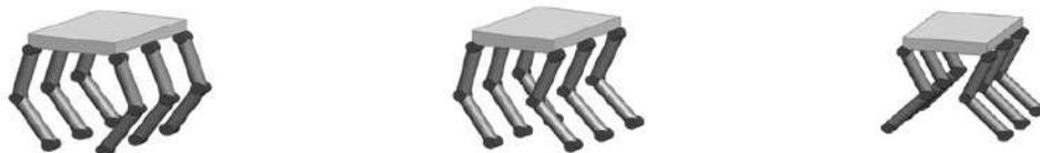
FIGURA 10. Orientación de las rodillas.
