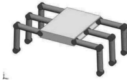
FIGURA 15. Configuración de un robot hexápodo.
