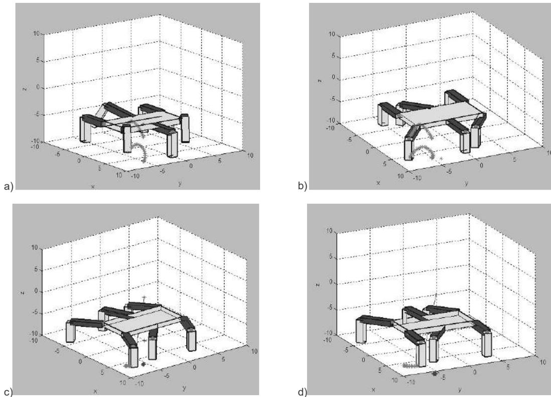
FIGURA 35. Simulación de la locomoción fija de un robot hexápodo en un entorno de MATLAB.
