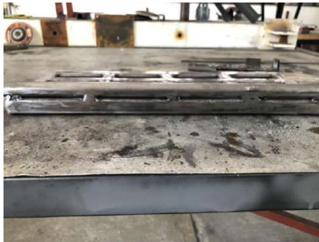
Figura 54 Unión entre pedal y barra redonda por medio de soldadura
