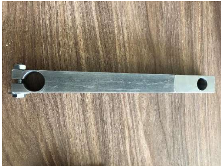
Figura 56 Maquinado de la barra cuadrada que funcionará como eslabón impulsor
