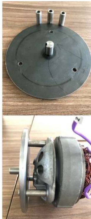
Figura 60 Maquinado y ensamble del volante de inercia y adaptador
