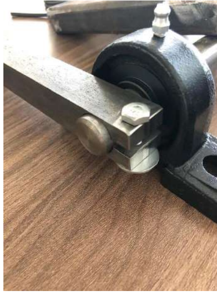
Figura 57 Ensamble de la barra cuadrada en uno de los extremos de la barra redonda
