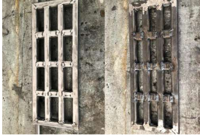
Figura 52 Estructura del pedal soldado y pulido
