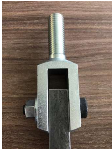
Figura 58 Ensamble de la cabeza de horquilla con el extremo restante de la barra cuadrada por medio de un tornillo con guía
