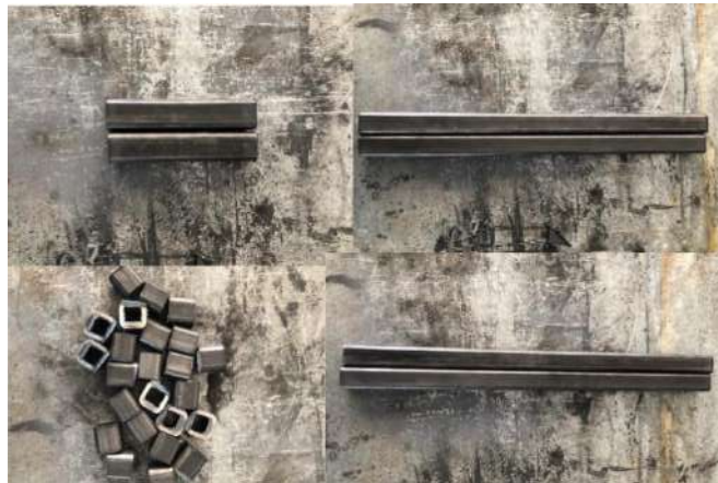
Figura 51 Cortes de PTR para la estructura del pedal
