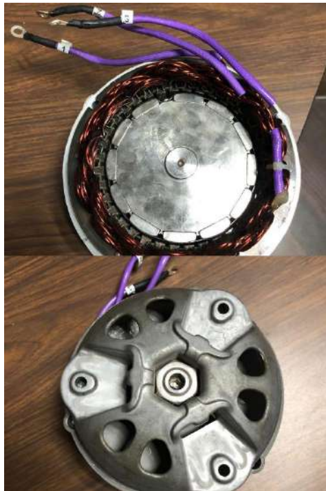
Figura 46 Embobinado y disco de imanes del generador eléctrico eólico Air Breeze
