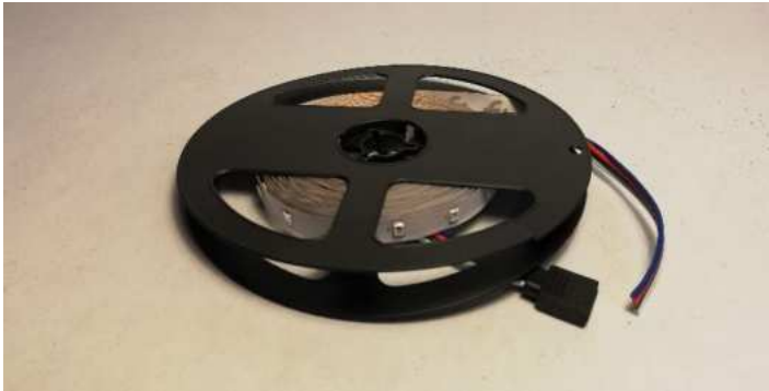
Ilustración 21 Tira LED RGB utilizada en prototipos funcionales. Elaboración propia.
