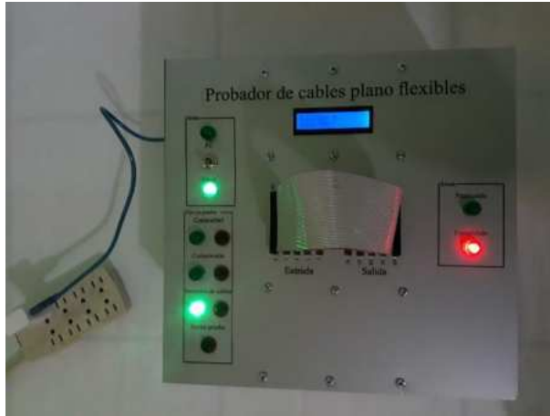
Fig. 4.30 Prueba de Cables cruzados en modo Portable.
