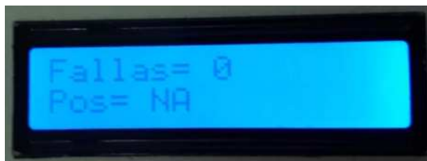
Fig. 4.31 Resultado de prueba de Cable sano en modo Portable.
