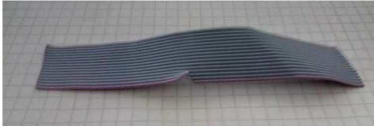
Fig. 4.3 Cable con falla de continuidad.
