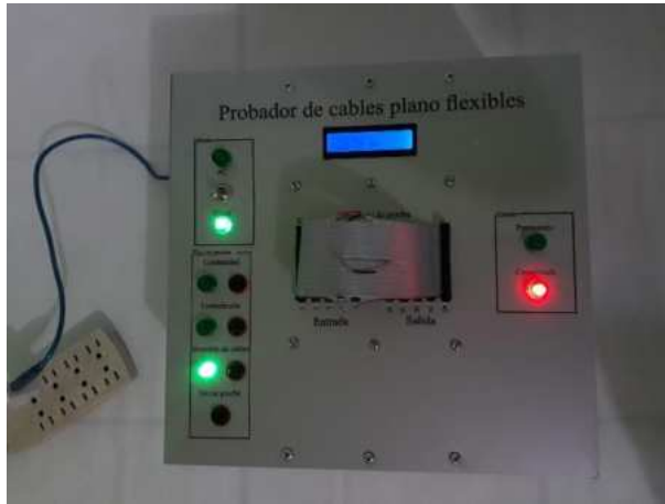
Fig. 4.28 Prueba de Cables cruzados en modo Portable.
