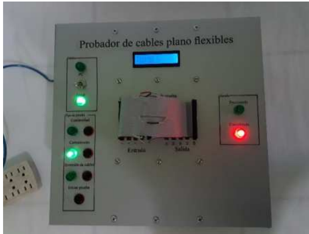
Fig. 4.26 Prueba de cortocircuito en modo Portable.
