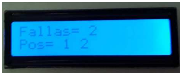
Fig. 4.25 Resultado de prueba de Continuidad en modo Portable.
