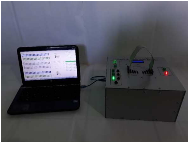
Fig. 4.21 Prueba de cortocircuito realizada en modo PC.
