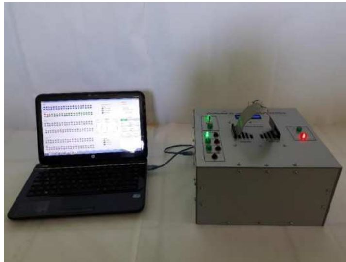
Fig. 4.15 Prueba de continuidad realizada en modo PC.
