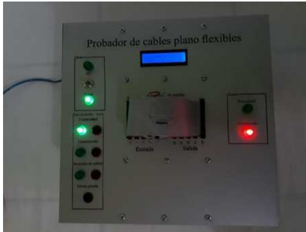
Fig. 4.24 Prueba de continuidad en modo Portable.
