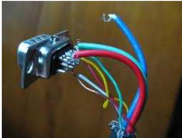
Fig. 2.2 Falla en cable debido a desconexión de terminales en cables.
