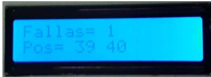
Fig. 4.29 Resultado de prueba de Cables Cruzados en modo Portable.
