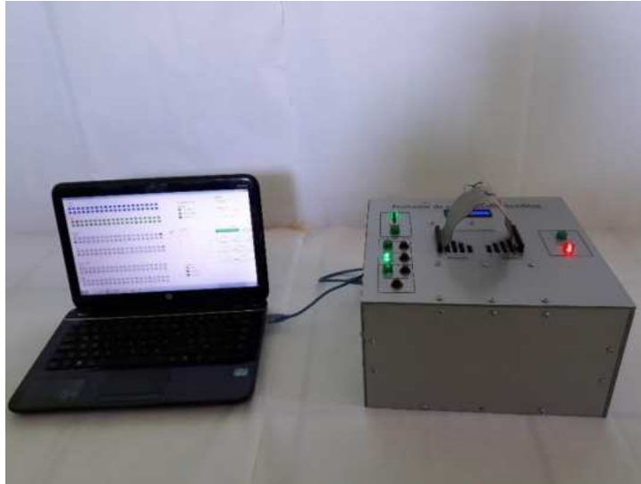
Fig. 4.17 Prueba de cortocircuito realizada en modo PC.
