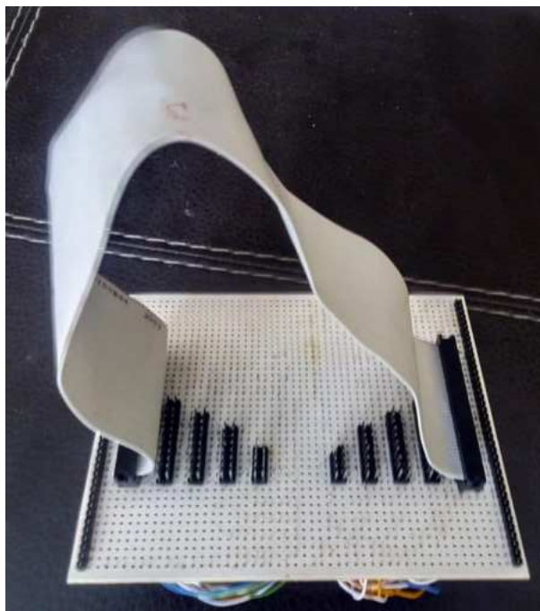
Fig. 3.7 Cable plano-flexible montado sobre la base de pines.
