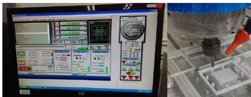
Figura 9. A) Pantalla CNC, B) maquinado de la placa de cierre y flujo
