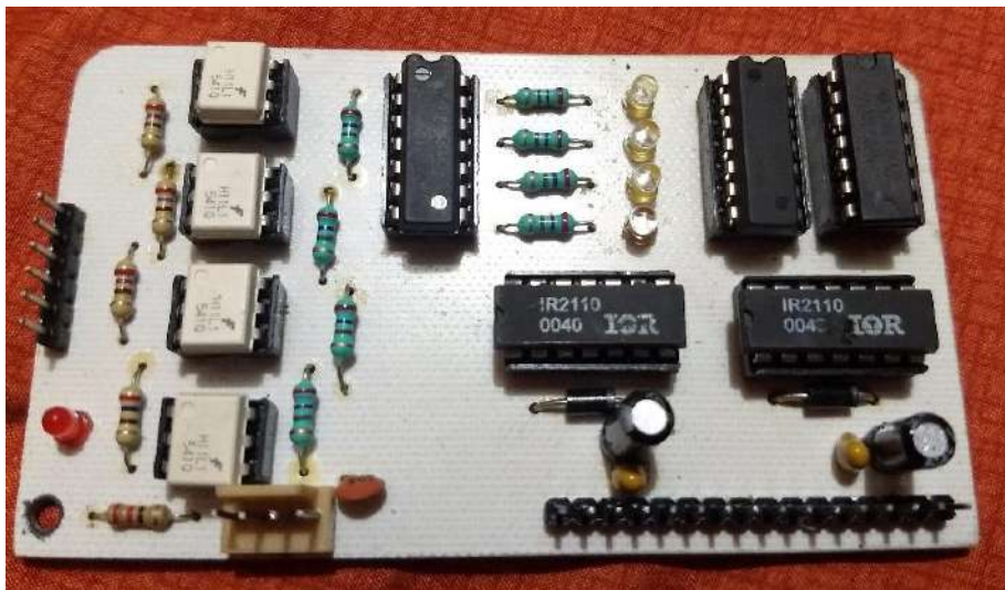
Figura 48 PCB #1 con las señales digitales y drivers.
