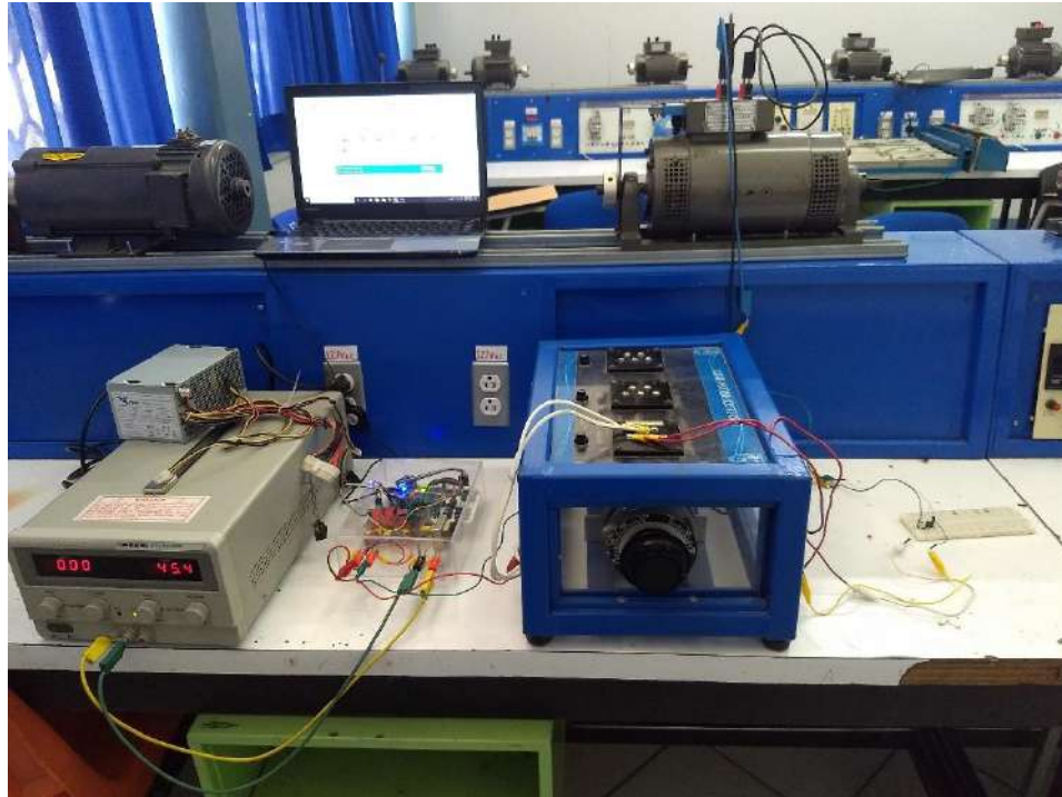
Figura 42 Interconexión para prueba con motor eléctrico de DC.
