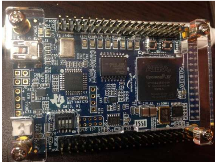
Figura 24 Tarjeta ALTERA DE0- Nano Cyclone IV EP4CE22F17C6N.
