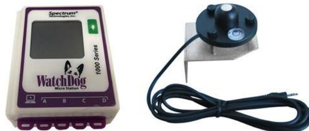
Figura 6. Micro estación WatchDog® 1000 Series y Sensor de luz LIGHTSCOUT®
