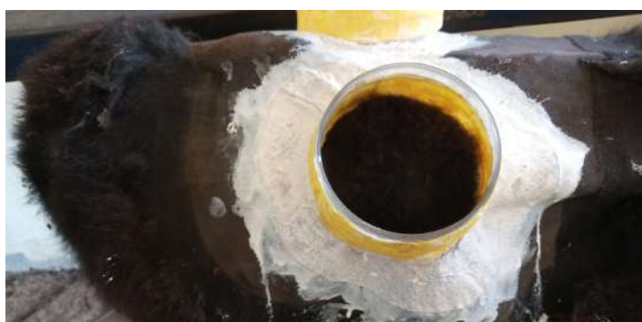
Figura 14. Parches con capa extra de pegamento para asegurar que no se separe. Fotografía original.
