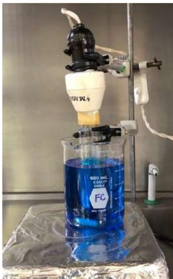
Figura 9. Sistema empleado para probar la eficiencia fotocatalítica de las nanopartículas.
