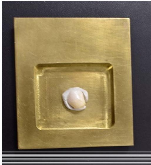
**Ilustración 14. Muestra Grupo 1 montada en el porta muestras del Difractómetro de Rayos X.**
