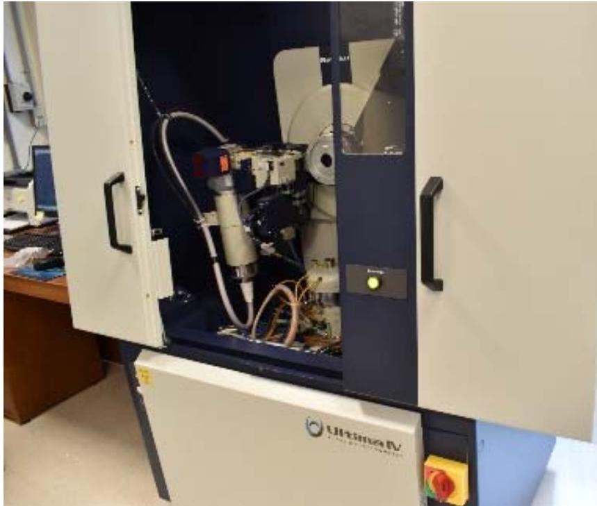
**Ilustración 15. Difractómetro de Rayos X RIGAKU, modelo Ultima IV.**
