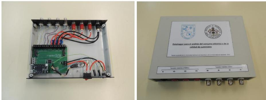
Figura 3-2. Sistema de adquisición de datos (DAS).
