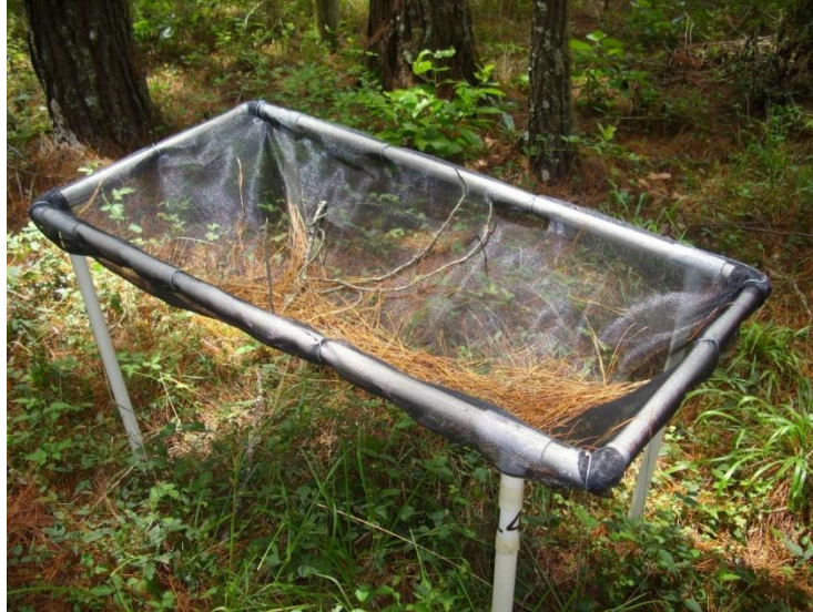
Figure 3.4 Diseño de trampa para hojarasca empleado en este estudio (0.5 m 2 ).
