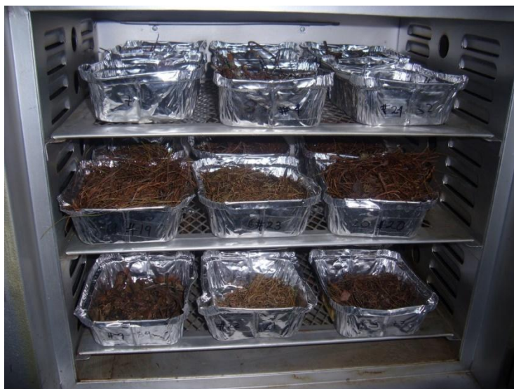
Figurf 3.5 Muestras de hojarasca en horno para secado de acero inoxidable Elvec ®.
