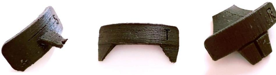
Ilustración 54. Impresiones 3D en PLA de los posicionadores /s/, /t/, y /r/ (Elaboración propia)
