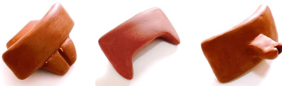
*Ilustración 55. Posicionadores con una capa exterior de plastilina (Elaboración propia)*
