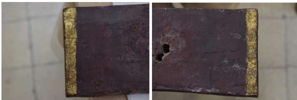
Ilustración 46 Reintegración con mica dorada
