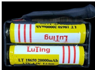
Figura 4.2.2 Baterías de Li-ion para alimentación.
