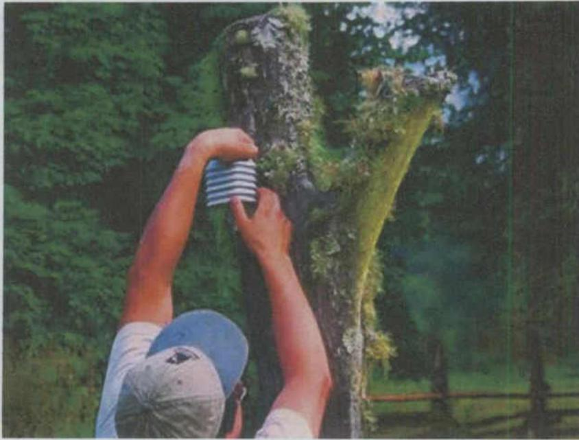
**Figura 3.3. Sensor de humedad y temperatura del aire ubicado fuera del bosque en El Pílon, Jalpan de Serra.**
