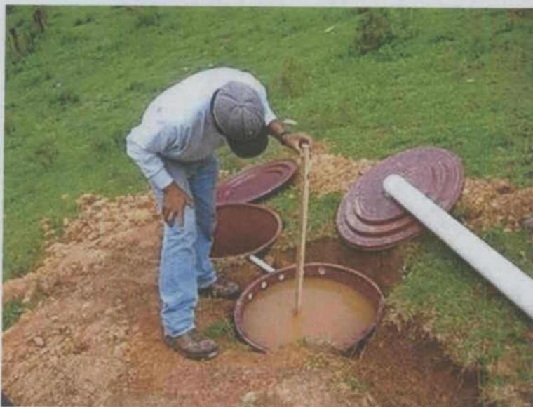
**Figura 3.10. Medición del volumen con ayuda de una regla de madera en la Parcela de Esgurrimiento instalada dentro del bosque de Pino en El Aserradero, Pinal de Amoles.**
