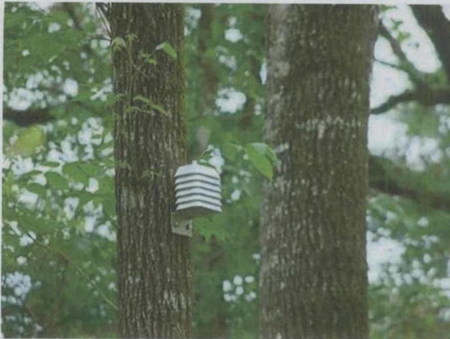
**Figura 3.2. Sensor de humedad y temperatura del aire ubicado en el bosque templado de encinos en El Pilón, Jalpan de Serra.**
