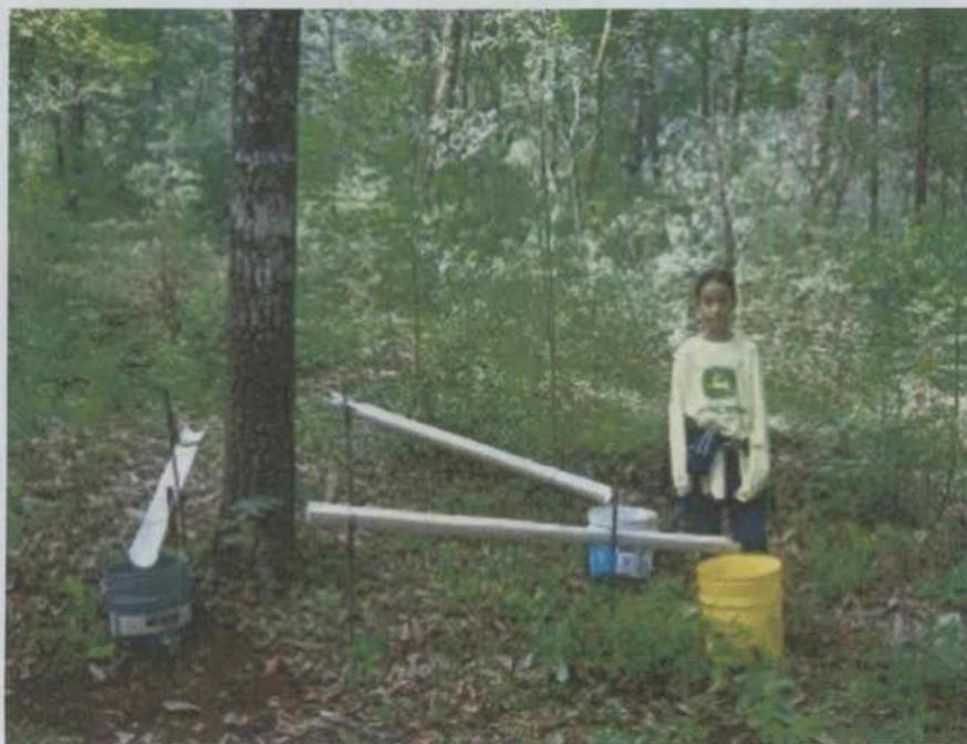
**Figura 3.7 Sistema de canaletas para medición de la interceptación de lluvia por la vegetación.**
