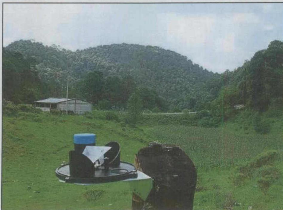
**Figura 3.4. Pluviómetro, sin tapa, mostrando el mecanismo de balancín en el Aserradero, Pinal de Amoles.**
