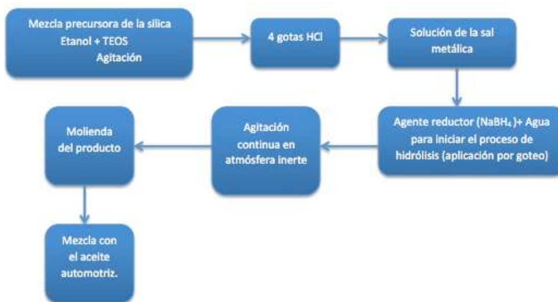
Figura 4. Ruta crítica general de síntesis para compósitos \text{metal@SiO}_2 .
