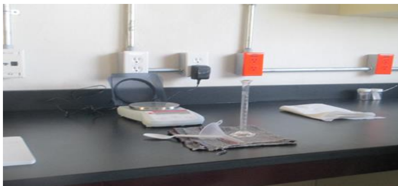
Figura 20.- Materiales para medir densidad aparente por el método de la probeta
