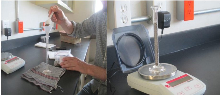
Figura 21.- Procedimiento para medir densidad aparente por el método de la probeta
