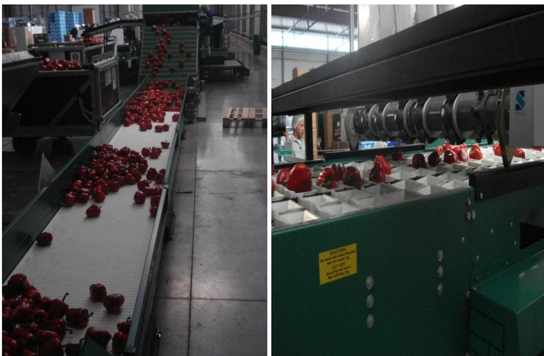
**Figura 8.** Transporte y etiquetado de pimiento morrón sobre bandas transportadoras.
