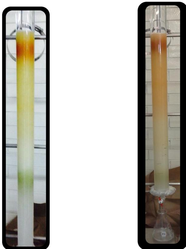
**Figura 15.** Cromatografía en columna abierta a la que fue sometida la fracción concentrada de alcaloides (FCA).
